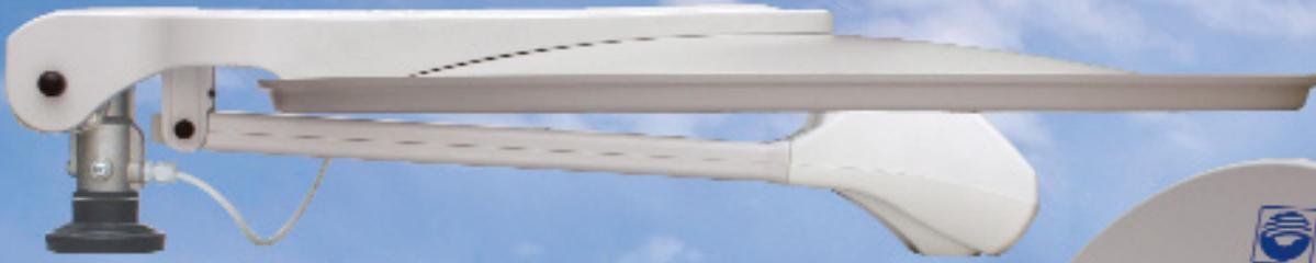
*Au cours du voyage l'antenne parabolique est complètement repliée sur le toit et ne fait que 17 - 18 cm de haut*
